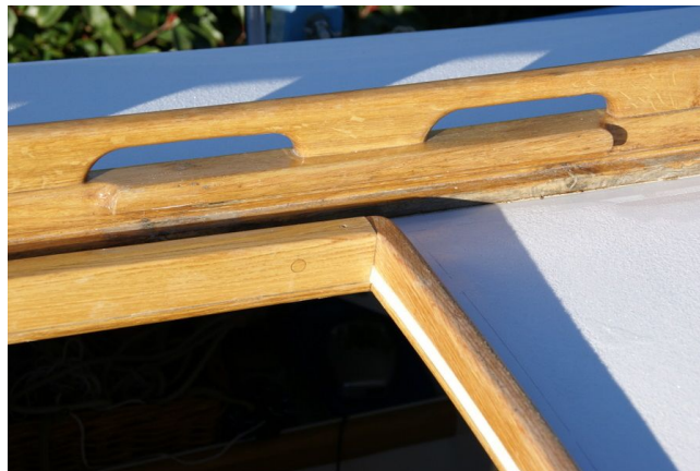
Angle avant de l'écouille montrant la continuité du surbau, qui n'est pas interrompu par la glissière comme c'est parfois le cas.
