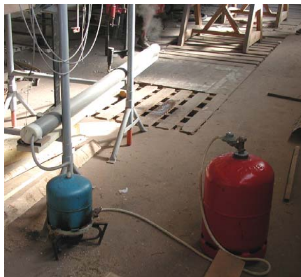
Exemple de réalisation : le tube est en PVC. On voit la vapeur fuir à l'arrière plan.
