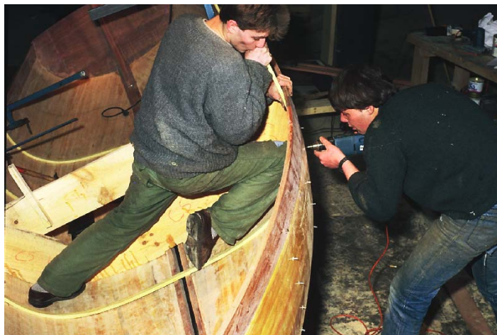
Pose d'une membrure sur un Aber, vissée au bordé © Francis Holveck à Douarnenez
