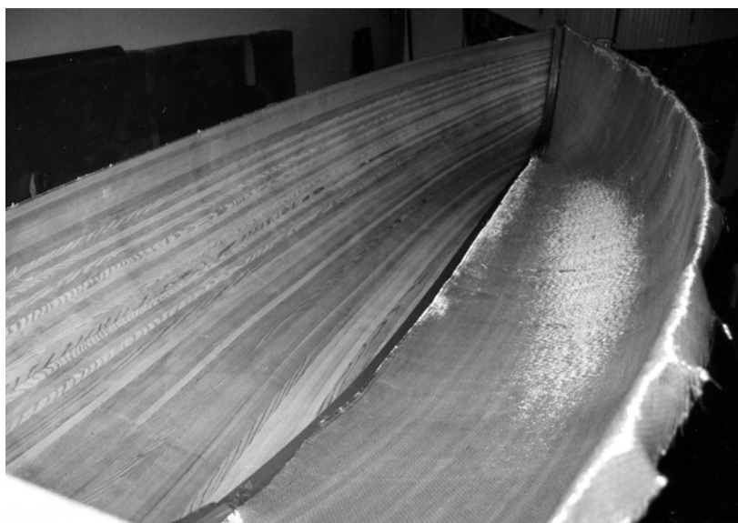
Présentation du tissu avant stratification sur un Aber en petites lattes
