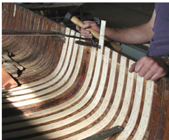
Restauration d'un canoë : on utilise des pointes retournées sur des membrures très souples (faible épaisseur sur le tour)
