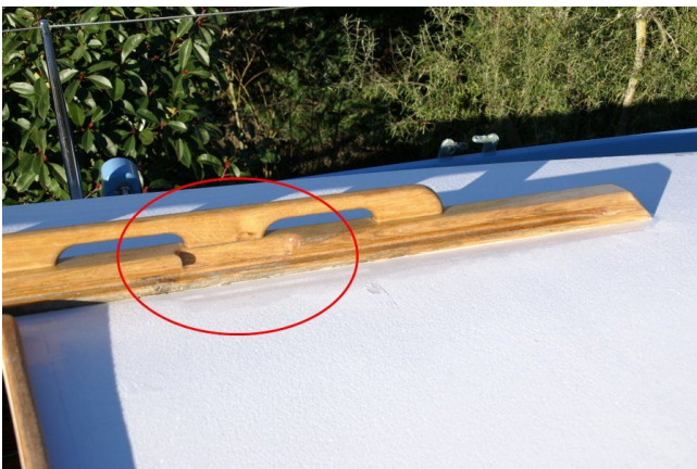
Le cercle montre une encoche. L'espacement des encoches doit être le même que celui des taquets coulissants.
