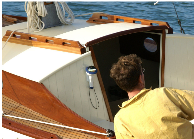
Vue d'ensemble de la descente d'un Méaban Les glissières sont extérieures au panneau coulissant Noter les mains-courantes, utiles sur tous les bateaux.
