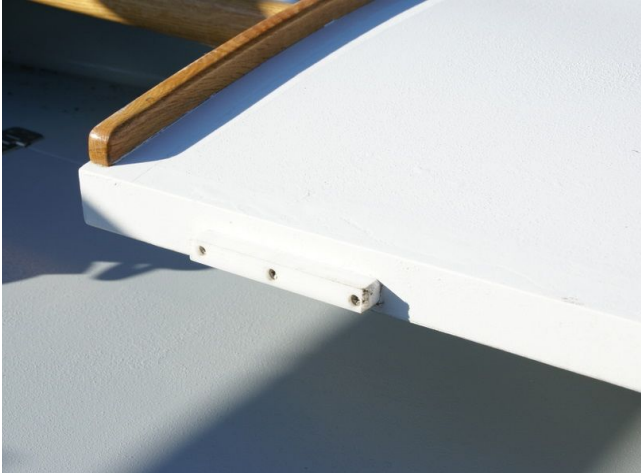
Taquet coulissant en matériau synthétique, ici du POM-C (polyacétal copolymère) qui glisse bien et s'use peu.
