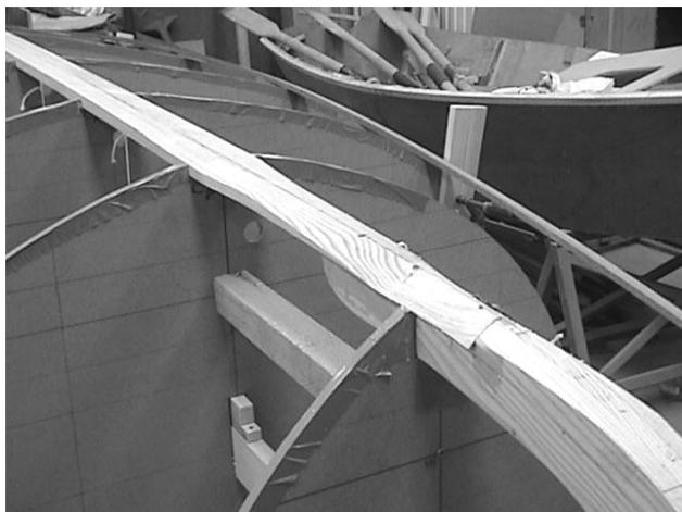
Ce n'est qu'après la pose de la quille que l'on pourra équerrer la zone du brion (partie inférieure de l'étrave). On rabotera en simulant les bordés avec une planche souple.
