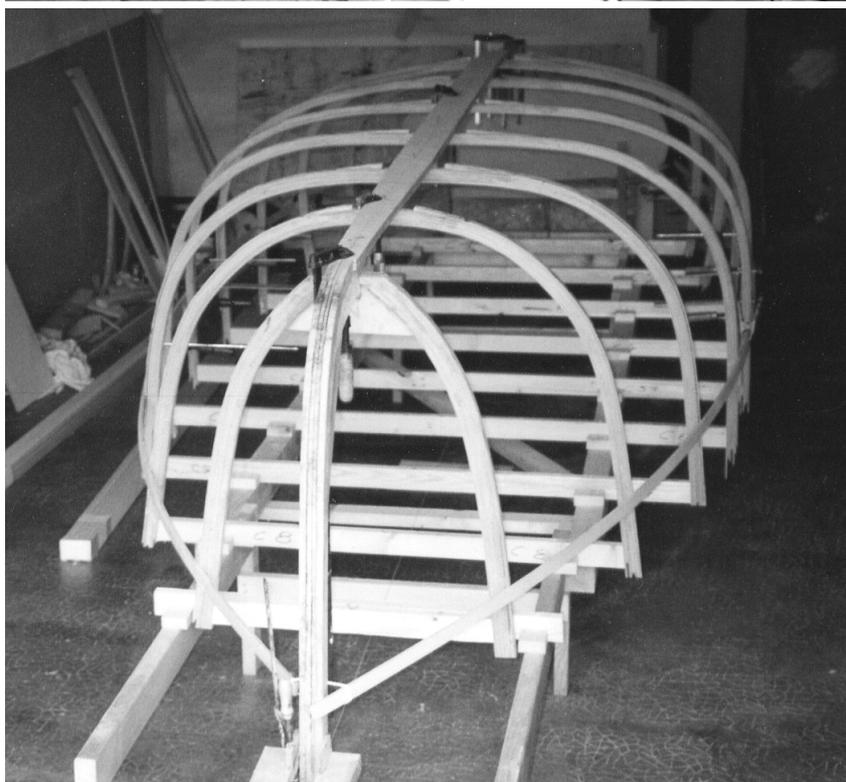
*Aber en construction, lui aussi sur membrures. Etrave, quille et tableau sont en place. On voit bien les « remplis », de part et d'autre de la quille, qui assurent le contact entre membrure et bordé au voisinage de la quille.*
