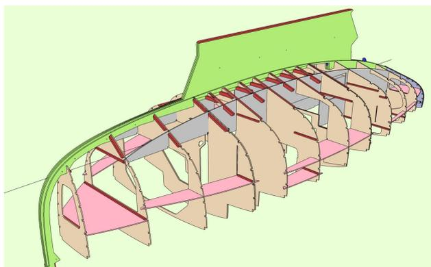
Sur une structure constituée de cloisons transversales et longitudinales de contreplaqué, on pose un bordé de fond en contreplaqué développable et des flancs en bois moulé de contreplaqué. Cela donne une belle coque en forme très facile à monter à partir de pièces découpées sur machine à commande numérique.
