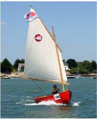
Morbic 12 est conçu pour être construit à partir d'un kit de contreplaqué découpé sur machine à commande numérique, ce qui en fait un bateau bien adapté au constructeur débutant ou pressé.
