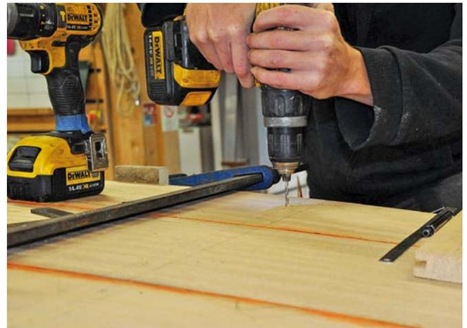
La sole est vissée dans les varangues, un grand serre-joint transversal maintenant l'assemblage. On pourra appliquer un joint d'Ettan sur les surfaces de contact
