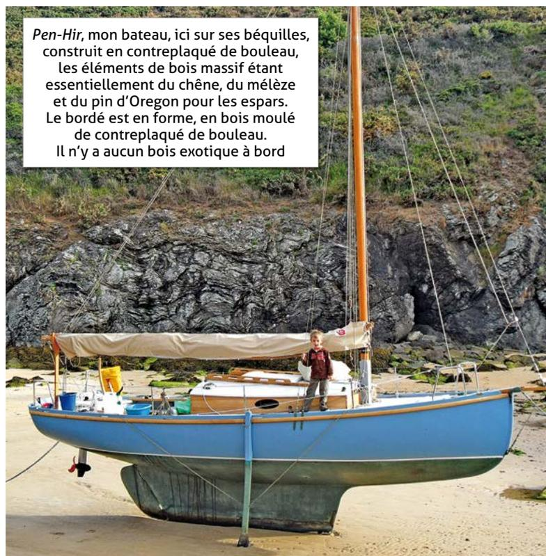
Pen-Hir, mon bateau, ici sur ses béquilles, construit en contreplaqué de bouleau, les éléments de bois massif étant essentiellement du chêne, du mélèze et du pin d'Oregon pour les espars. Le bordé est en forme, en bois moulé de contreplaqué de bouleau. Il n'y a aucun bois exotique à bord
