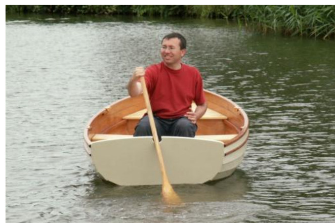
Grand Morbic à la godille. Les deux ailerons améliorent la stabilisation transversale.
